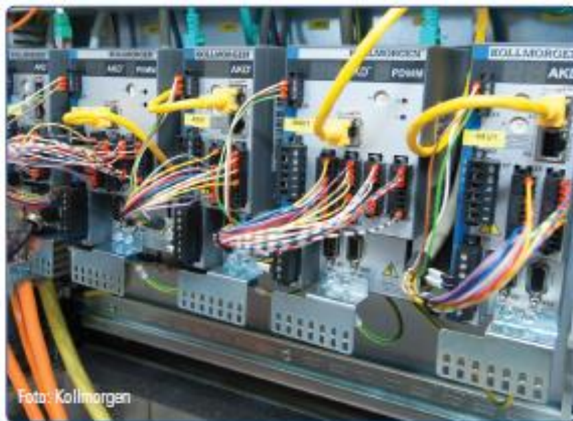
Gli intelligenti servoconvertitori della serie AKD PDMM offrono la capacità di calcolo di un "IPC inside". La comunicazione avviene mediante EtherCAT.
